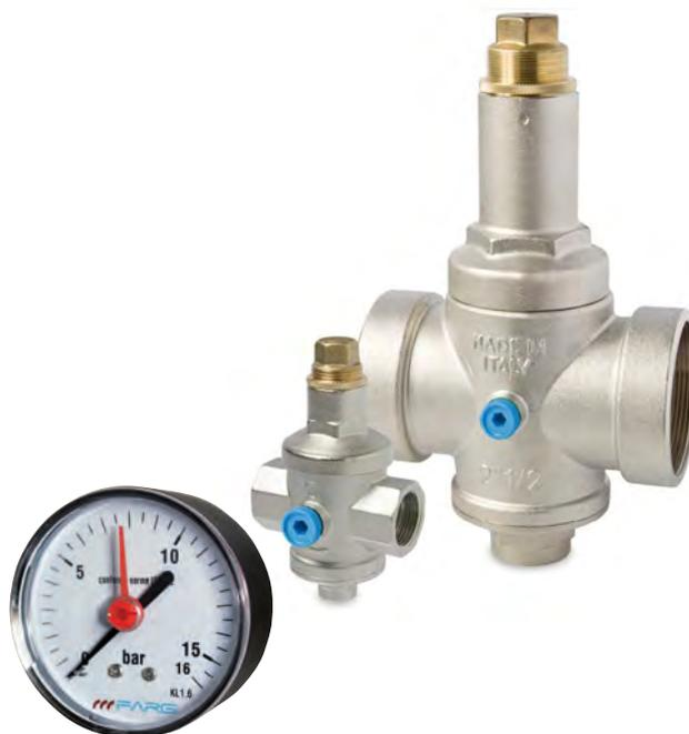
A válvula redutora de pressão F.F. é adequada principalmente em aplicações civis e industriais que exigem um fluxo médio a alto, com o valor agregado de um assentamento de aço inoxidável. A sua principal característica é a operação do pistão com câmara de compensação. A conexão ao sistema é feita através de conexões fêmea roscadas ISO 228/1. Duas ligações G 1/4 " no corpo da válvula redutora de pressão permitem a instalação de um manómetro.
